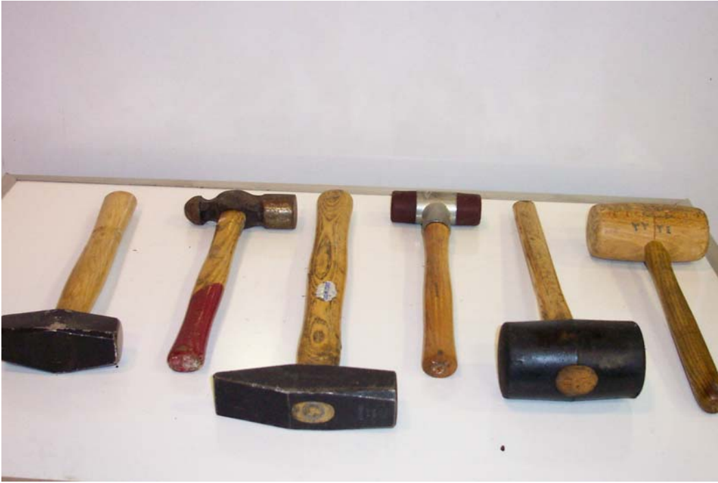
الشكل (٢-٣) يبين مجموعة من المطارق المستخدمة في صيانة الشاحنات
