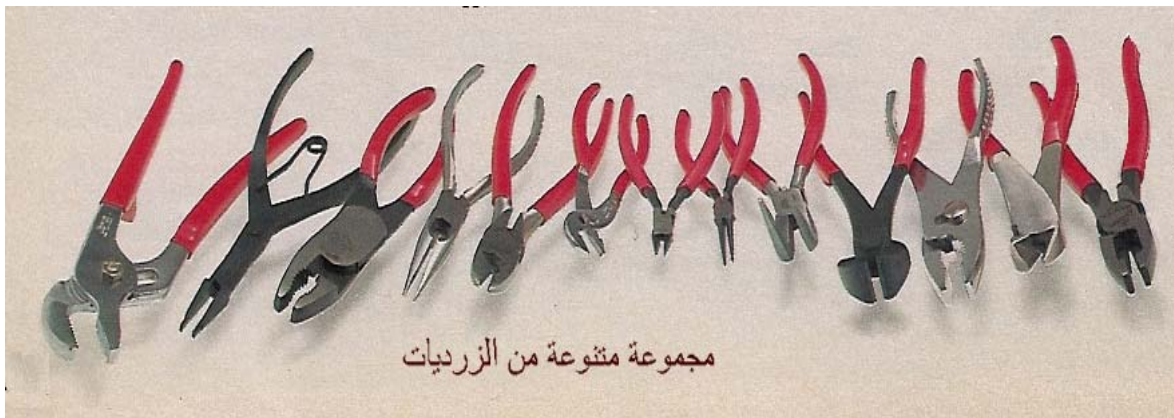
الشكل (٤-٣) يبين عدة أنواع من الزرديات والمفاتيح الصندوقية والعادية
