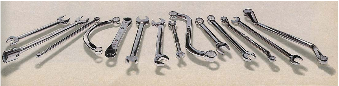
الشكل (٣-٦) يبين عدة أنواع من المفاتيح الصندوقية والعادية
