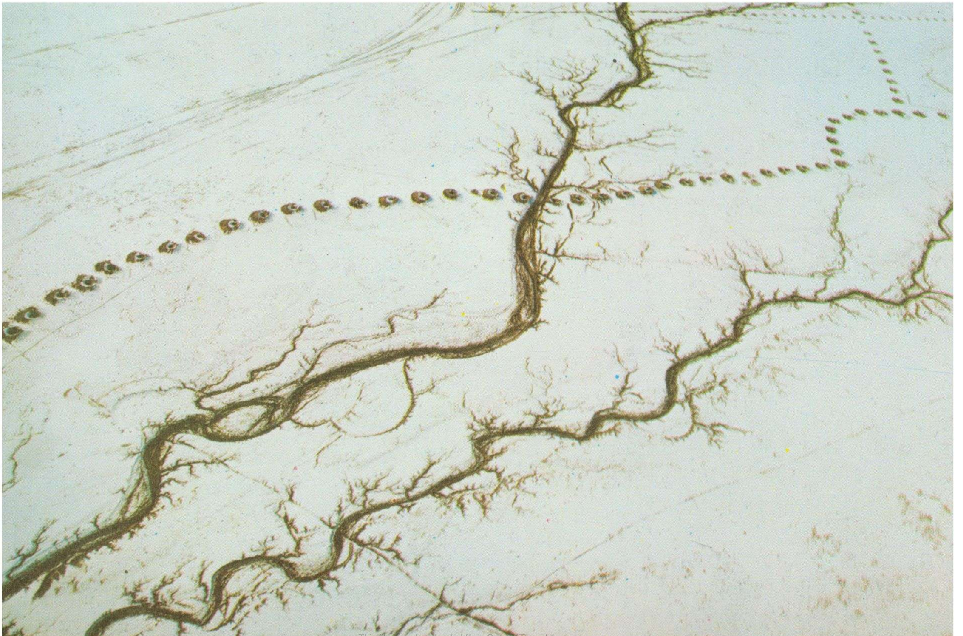
١٤٣ هذا المجرى المائي تحت الأرض يمثل قناة تحمل الماء من سفوح الجبال إلى السهول المنخفضة في الأقاليم الواقعة بين إصفهان وكاشان .
