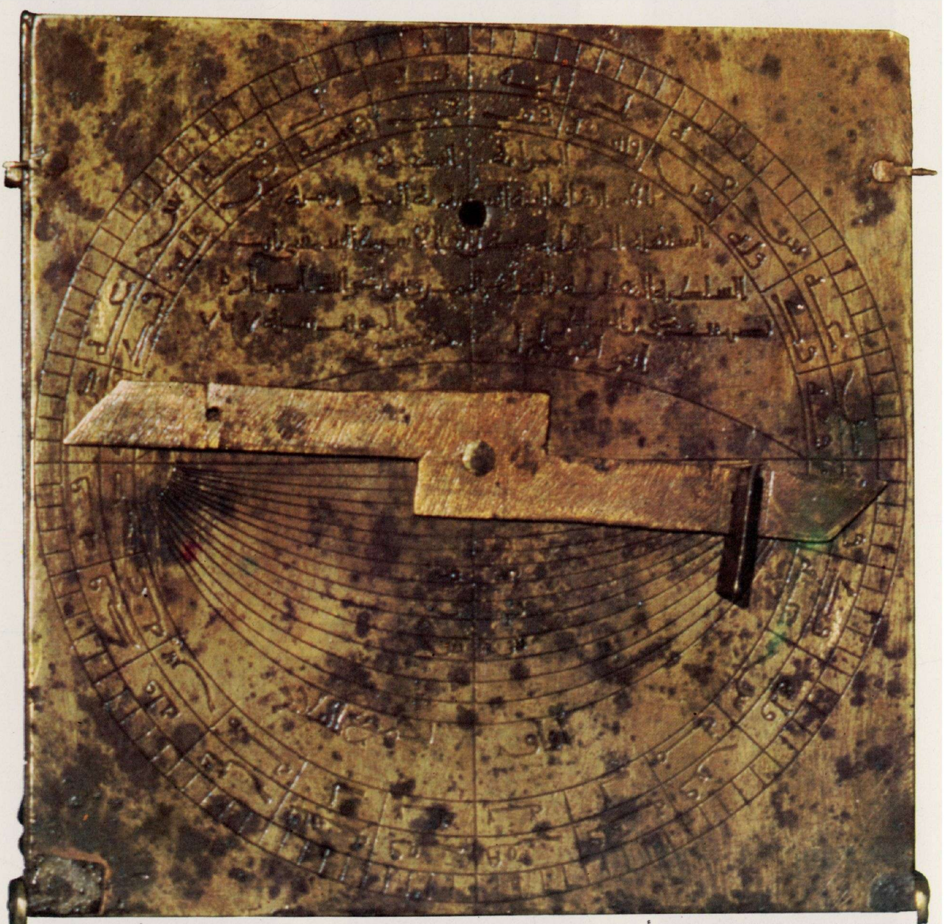
٤٩ تمثل هذه الصورة مزولة كانت تستعمل أيضا لايجاد سمت القبلة ونلاحظ فيها عدة اجزاء مشار لها برموز مع ورود كلمة مكة في أكثر من مكان وهي ترجع الى القرن الثاني عشر للهجرة / الثامن عشر للميلاد .
