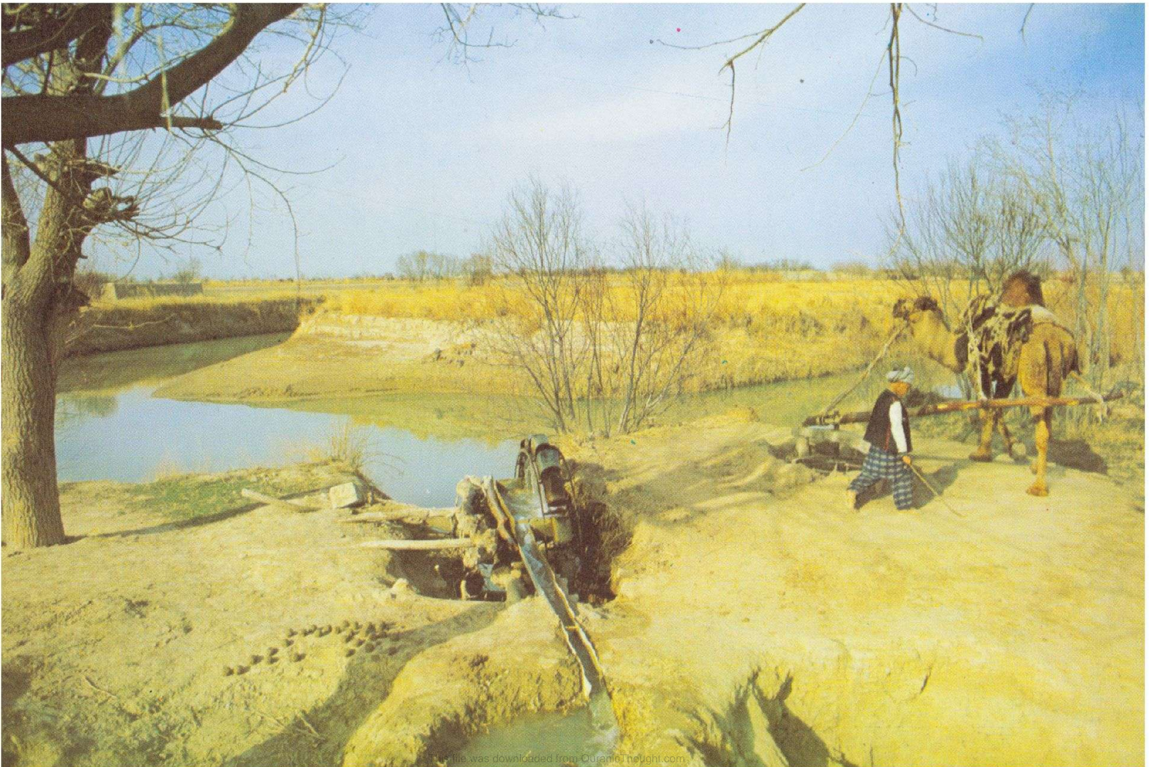
١٤٧ ان مهمة الرجل الظاهر في الصورة تتمثل في تنشيط الجمل حتى يقوم بالدور الموكل له في عملية تدوير العجلة المائية . والصورة مأخوذة في افغان التركستانية .
