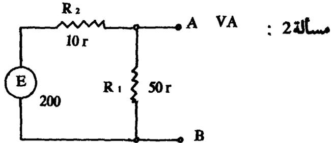
احسب قيمة الفولطية  $V$  في النقطة A للدائرة الكهربائية الموجودة في الصورة أعلاه .
